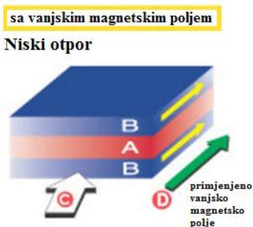
Slika 9.26: Struktura slojeva uz utjecaj vanjskog magnetskog polja
