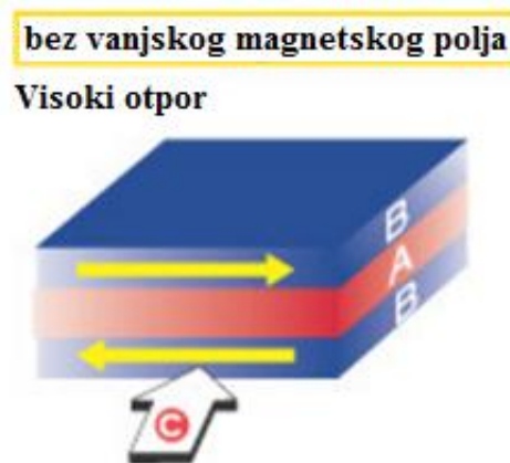
Slika 9.25: Struktura slojeva bez utjecaja vanjskog magnetskog polja
