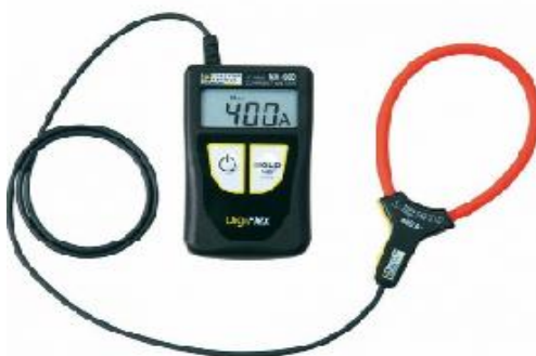
Slika 7.2: Strujna kliješta sa “čeljustima“ na kabele
