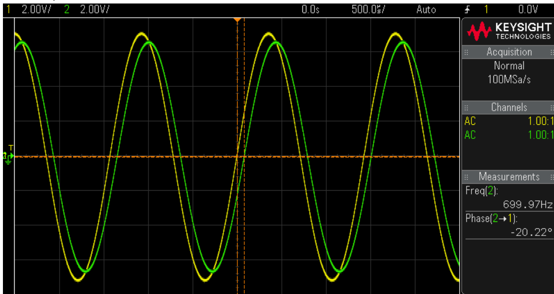
Slika 3.14. Prikaz valnih oblika povećanjem frekvencije
