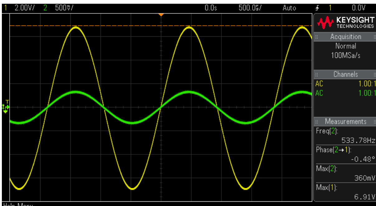
Slika 4.10. Prikaz valnih oblika na rezonantnoj frekvenciji
