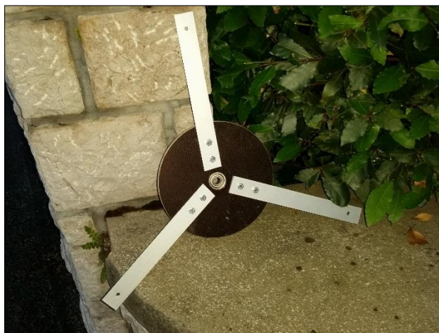
Slika 4.5.: Drveni disk s nastavcima i kugličnim ležajem
