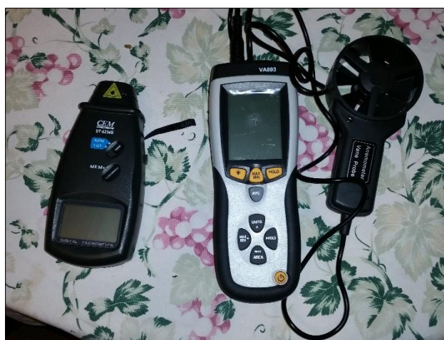
Slika 4.20.: Digitalni tahometar i anemometar
