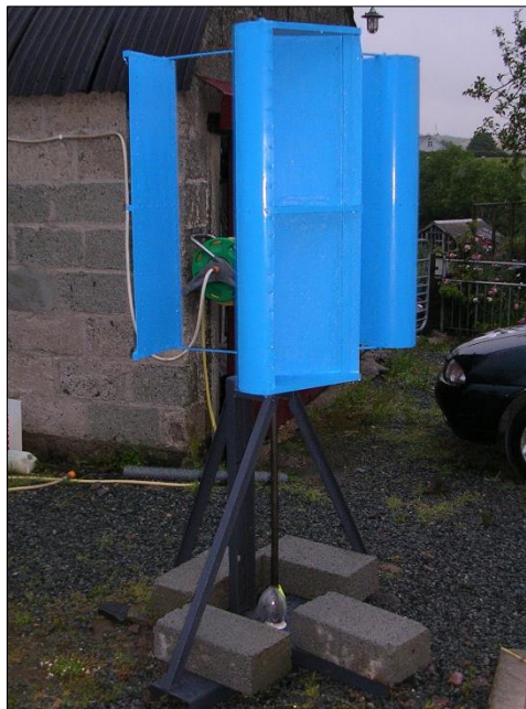
Slika 4.1.: Primjer Lenz2 vjetroagregata kućne izrade
