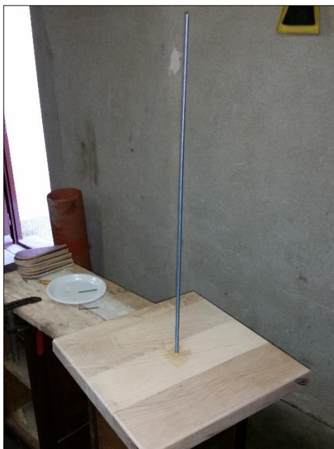
Slika 4.4.: Osovina ugrađena u drveno postolje
