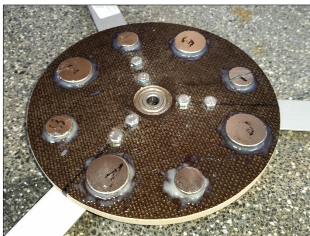
Slika 4.12.: Rotor s neodimijskim magnetima
