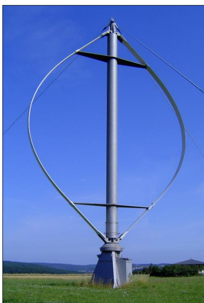
Slika 3.4.: Darrieusova turbina s dvije lopatice
