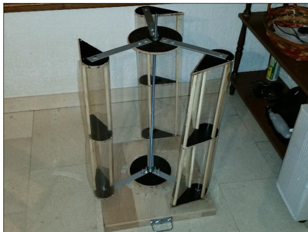
Slika 4.17.: Dovršeni model malog vjetroagregata
