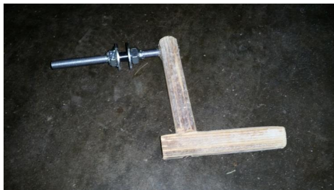
Slika 5.1.3 Alat za namatanje
