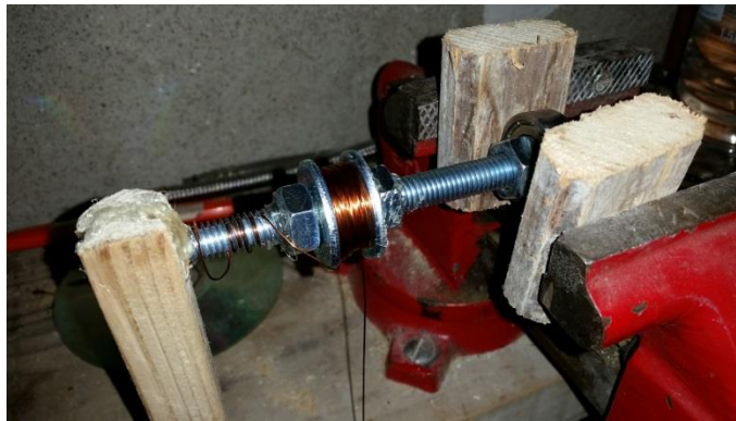
Slika 5.1.3.1 Izrada namota statora
