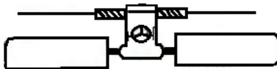
2.13. Prigušivač vibracija Stockbridge
