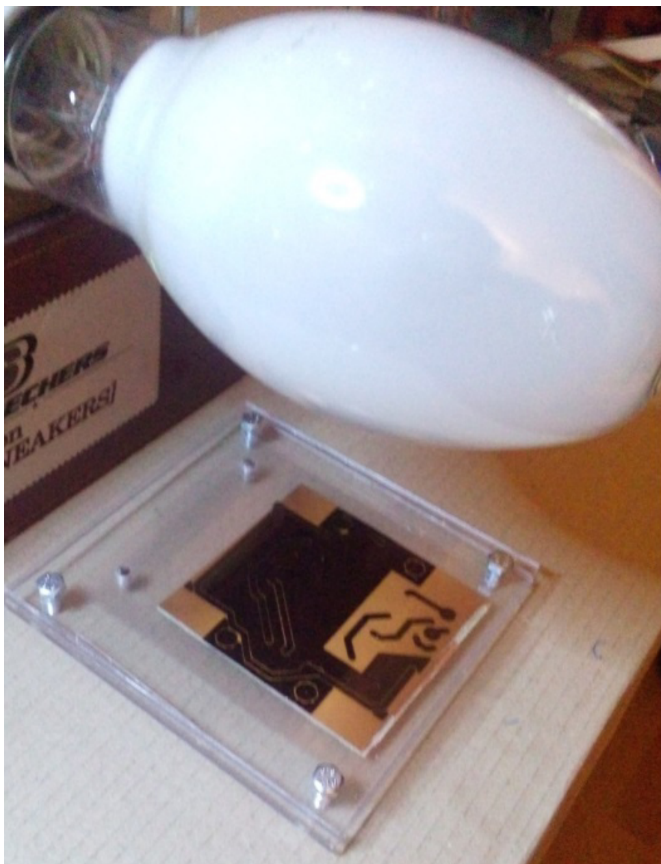
Slika 6.2. Tiskana pločica i fotofilm pričvršćeni u predložak (foto: Filip Žic)
