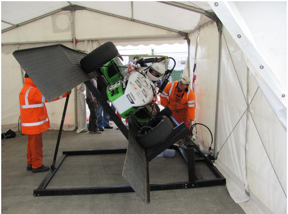
Vozilo nagnuto  $60^\circ$  pri testu na izljevanje tekućina (2. dan)
