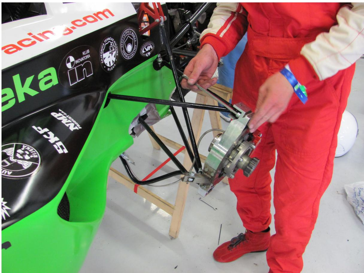
Tijekom isprobavanja vozila, nakon natjecanja u sprintu, oštećena je donja vilica kotača
