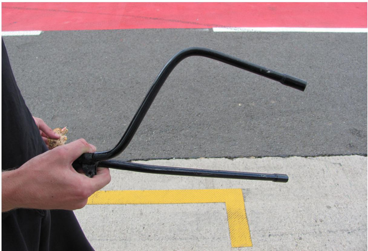
Skinuta oštećena vilica kotača. Vozilo je bilo onesposobljeno za daljnja natjecanja i sudac je odmah skinuo naljepnicu tehničkog pregleda. Bilo je potrebno izraditi novu vilicu za nastavak natjecanja. Vozilo je sljedeći dan trebalo imati utrku izdržljivosti u 9:15 (3. dan)
