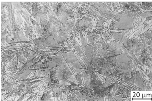
Slika 2.4. Karakteristična mikrostruktura perlita i sekundarnog cementita, 500:1
