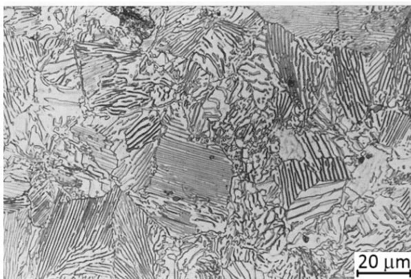
Slika 2.3. Karakteristična mikrostruktura perlita, 500:1
