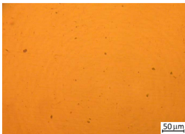
Slika 4.51. Metallografski snimak uzorka 8 nakon poboljšavanja, nenagrizano, polirano, 200:1
