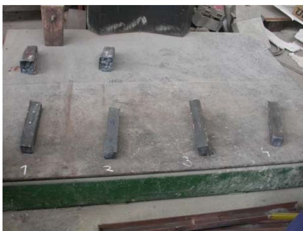
Slika 4.12. Gredice neposredno nakon lijevanja
