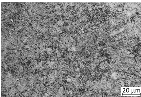
Slika 2.5. Karakteristična mikrostruktura martenzita, 500:1
