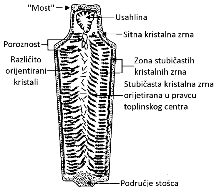
Slika 3.8. Shematski prikaz presjeka ingota
