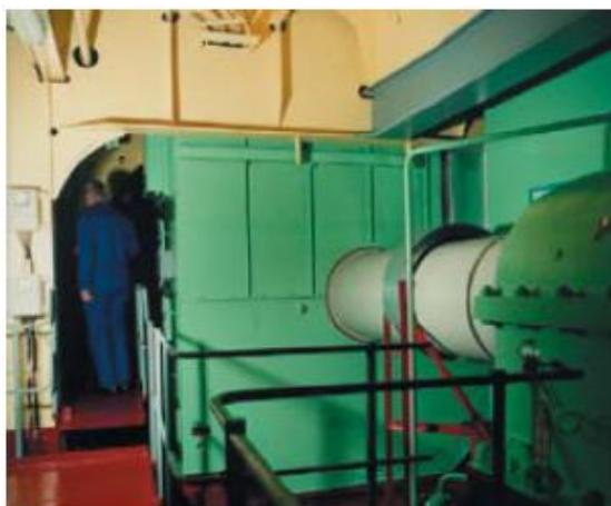
**Slika 3.23** Tipični osovinski elektromotor/generator za oko  $6\text{ MW}_e$  snage ugrađen na međuosovinu broda za prijevoz kontejnera (Siemens) [10]
