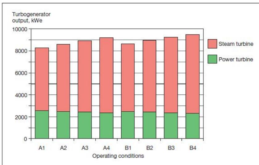
**Slika 3.25** Izlazne snage parne turbine i plinske turbine (turbine snage) pri različitim radnim uvjetima za Wärtsilä 12RT-flex96C motor pri 100% opterećenja [10]
