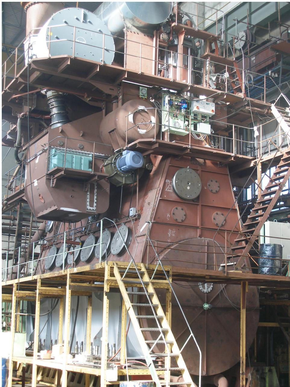
Slika 4.3 Ispitivanje motora 6S70MC MAN-B&W na ispitnom stolu u TDM – Split
