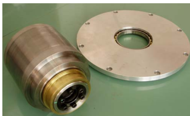
Slika 5.3. Rotorski dio AML (lijevo) i poklopac kućišta s prihvatnim ležajevima (desno)
